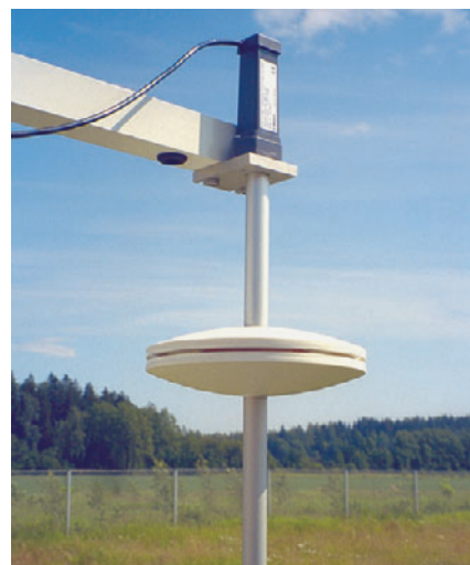
Ein PTB210 kombiniert mit dem Druckkopf SPH10 an einem Ausleger
