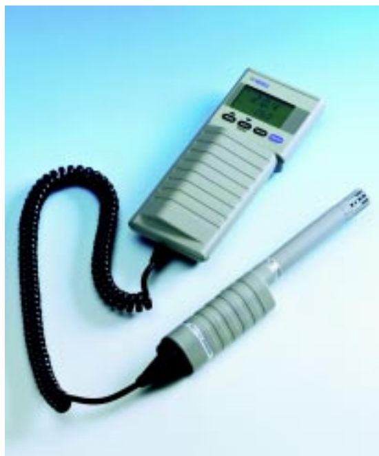
HMI41-näyttölaite ja HMP45-mittapää
